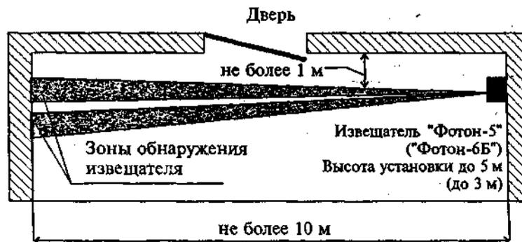
Рис.9. Блокировка двери и окон на проникновение извещателями пассивными оптико-электронными с зоной обнаружения типа "занавес"
